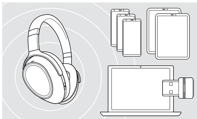
Bluetooth 経由でデータを伝送するには、まず、ヘッドセットを無線デバイスにペアリングする必要があります。付属の dongle は、ヘッドセットと既にペアリングされています。
