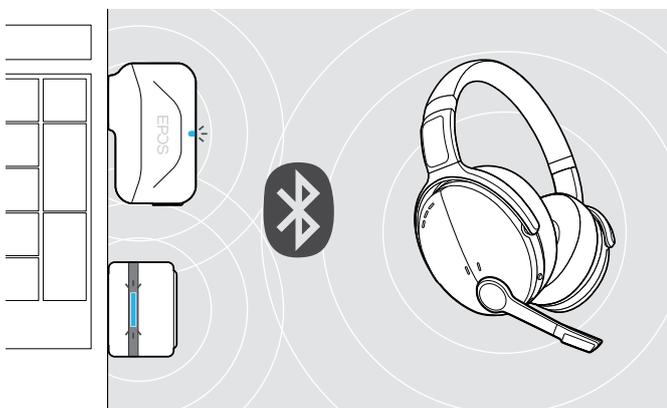
Le voyant à LED du dongle clignote en bleu en mode recherche et passe en plus faible lorsque le dongle est connecté au micro-casque.
