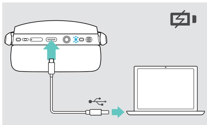
La batterie est en cours de chargement. Les voyants à LED s'allument en fonction de l'état de la batterie du micro-casque et s'éteignent lorsque la batterie est entièrement chargée.
